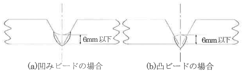
図4 TIG溶接後の計測(6mm以下)
